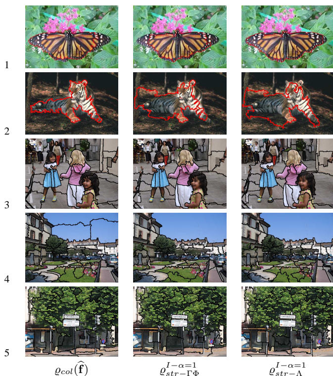
Figure 4 – Segmentation couleur vs. segmentation structurale par LPE. Exemples 1-2, marqueur pour l’objet; exemples 3-5 sélection des 50 volumiques.
